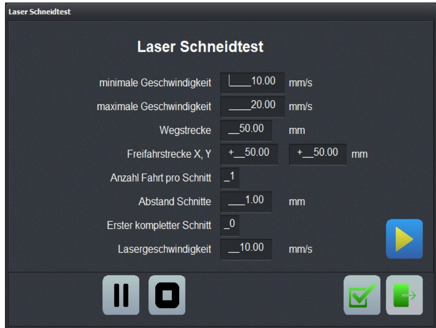
Laser-Schneidtest zur Ermittlung der optimalen Geschwindigkeit und Durchgängen
