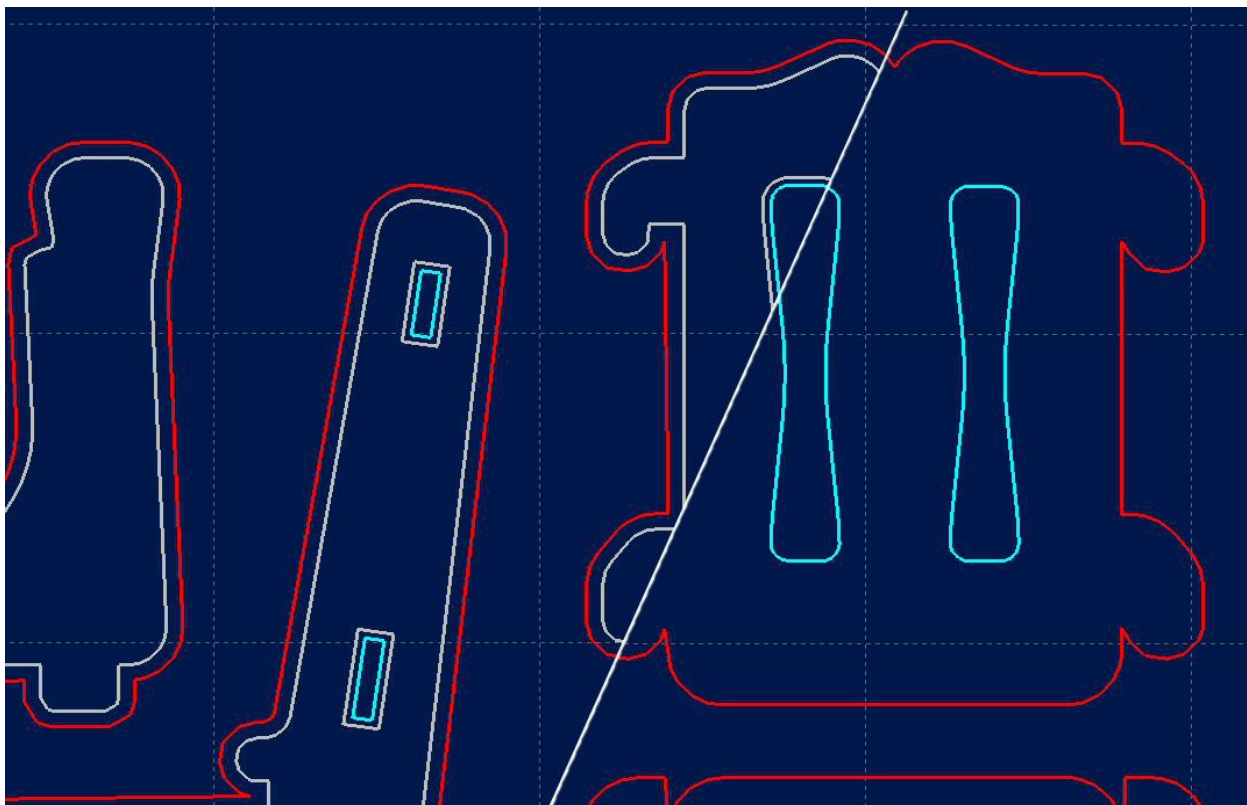
Objekt nach Radienkorrekturberechnung und mit/ohne Ansicht der Originalkontur
