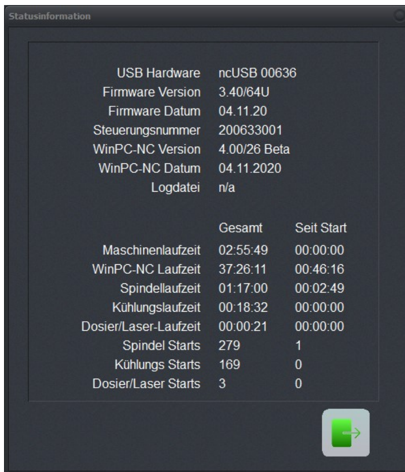
Statusinformationen, Anzeige der aktuellen Version, der erkannten Hardware und diverse Betriebsdaten und Laufzeiten
