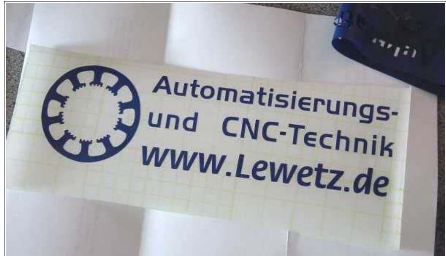
Beispiel für Folienschnitt mit Tangentialachse
