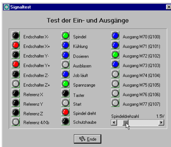
Sonderfunktion SIGNALTEST mit LED-Anzeigen der wichtigsten Eingänge
