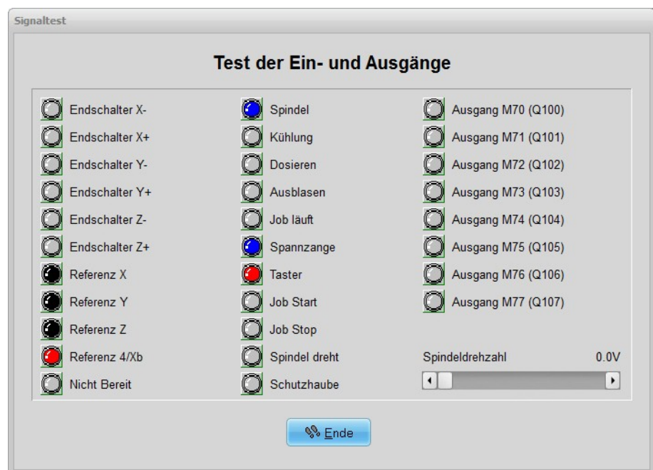
Sonderfunktion SIGNALTEST mit LED-Anzeigen der wichtigsten Eingänge
