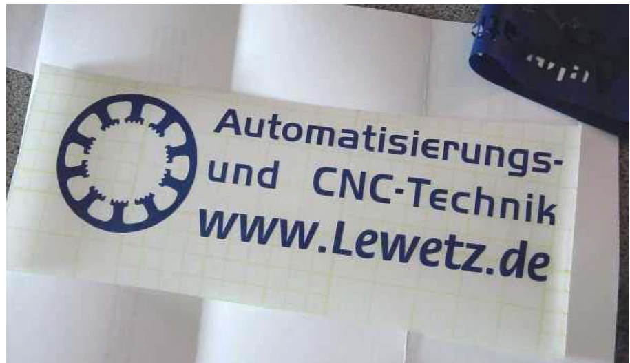
Beispiel für Folienschnitt mit Tangentialachse
