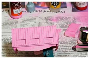
Die im oberen Bereich eingefrästen Lüftungsschlitze benötigten noch eine Metallabdeckung, durch die sie wieder so verschlossen werden sollten, dass kein "Federvieh" dort durchschlüpfen kann. Aus einer 0,15 mm dünnen Aluminiumfolie von "Albion Alloys" wurde ein Streifen mit einer Breite von drei Millimeter geschnitten ...
