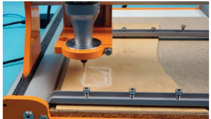
▲ Die Maschine ist nun für die Inbetriebnahme bereit. Über die beiliegenden Software Win-PC-NC-Starter aus dem Ingenieurbüro Lewetz wird die Maschine angesteuert. Wenn die Software installiert ist, kann damit die Maschine erstmalig „manuell gefahren“ werden, um zu überprüfen ob alle Achsen geräusch- und reibungsarm sowie spannungsfrei bewegt werden können.
