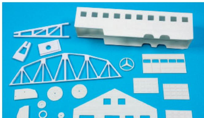
▲ Im erstem Arbeitsschritt werden mit einem feinen Gravierstichel (10°/0,1 mm V-Spitze) die horizontalen und vertikalen Fugen in die Polystyrolplatte graviert. Es entsteht so das Steinmuster auf der Kunststoffplatte.
