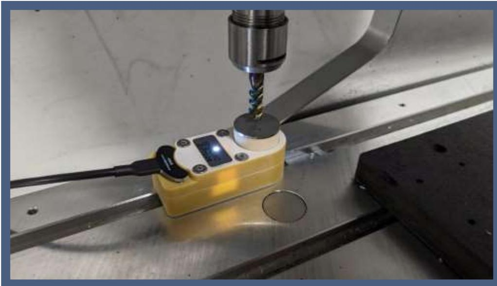
**In der Version V3.41/09 haben wir Prüffunktionen für Werkzeuge realisiert, mit denen ein Bruch und die korrekte Ablage oder Aufnahme im automatischen Wechsler überwacht werden können**
