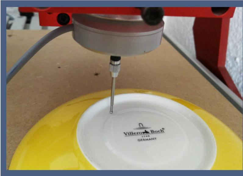
Mit einem geeigneten 3D-Taster oder Abtaststift lassen sich nicht-ebene Oberflächen von Werkstücken oder sogar ganze Maschinentische abtasten und als Messtabelle hinterlegen. Eine nachfolgende Bearbeitung mit Gravur oder Fräsung kann dann die Messwerte berücksichtigen und die Daten darauf projizieren.
