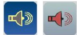
Nach einer Referenzfahrt oder bei einem Jobstart wird die Überwachung der kritischen Bereiche automatisch aktiviert und damit kann das nicht versehentlich vergessen werden. Der rote Button wechselt dann automatisch nach blau und zeigt damit die aktive Überwachung an.
