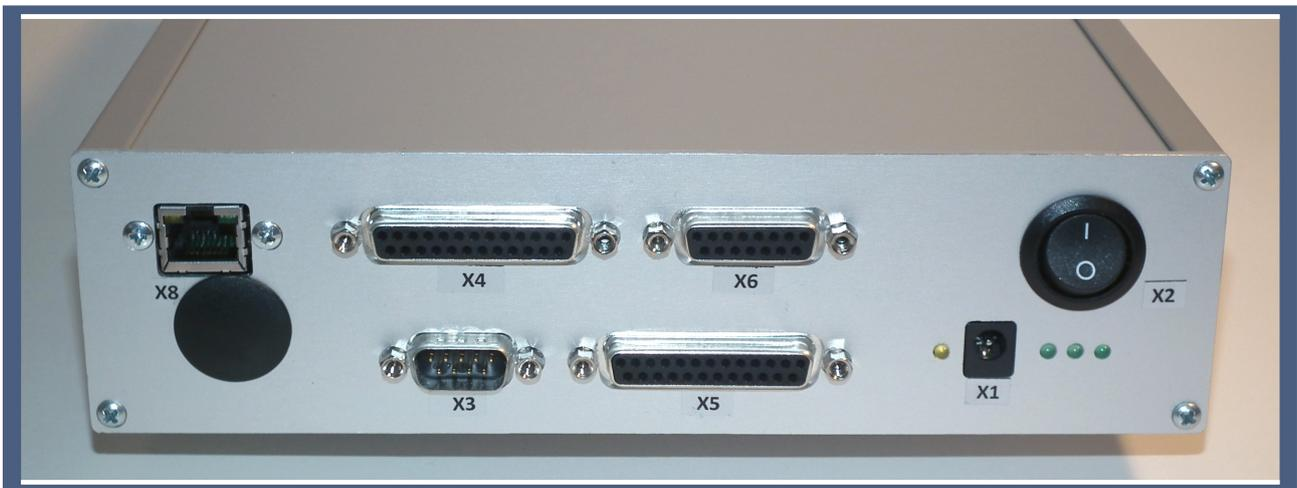
Der Anschluß des Achscontrollers erfolgt mit einem handelsüblichen CAT-Kabel und kann entweder direkt am Steuer-Computer oder über einen oder mehrere Switches in einem Netzwerk erfolgen. Damit ist auch der Betrieb in entfernten Räumen leicht möglich.
