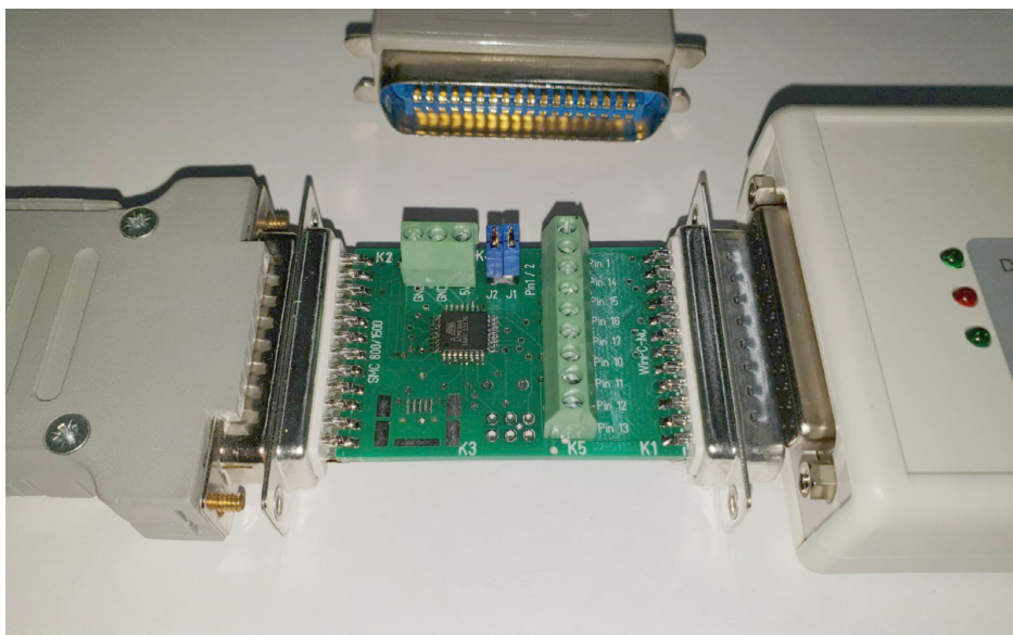
SMC 800/1500 Adapter, Links und oben Anschlusskabel zur SMC-Endstufe, rechts ncUSB-Modul
