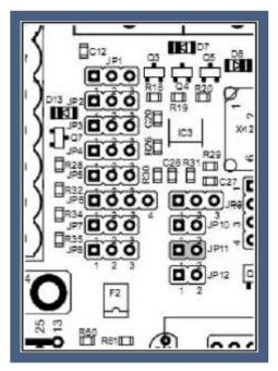
Mit Jumper JP11 kann die Startup-Zeit der Schrittmotorkarte beeinflusst werden. Mit offenem Jumper ist die Karte ca. 3 Sekunden nach dem Einschalten der Versorgung bereit und die Motoren bestromt. Mit gestecktem Jumper wird diese Zeit auf ca. 10 Sekunden verlängert. Damit kann unter Umständen sichergestellt werden, dass die übergeordnete Steuerung oder der PC mit Steuersoftware ebenfalls bereit und alle Signale in definiertem Zustand sind.
