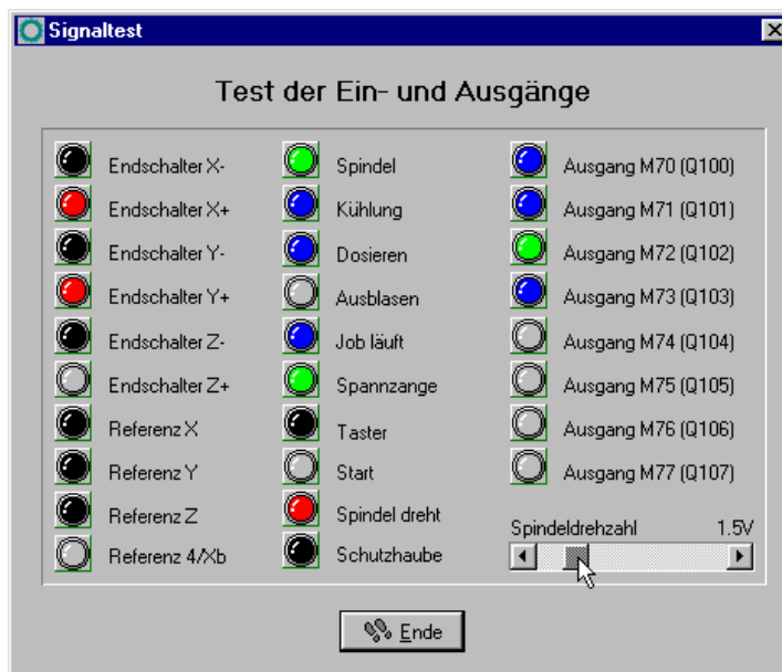
Sonderfunktion SIGNALTEST mit LED-Anzeigen der wichtigsten Eingänge
