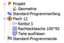
Im neuen *FILOU NC16* übernimmt der "Manager" das Verwalten und Strukturieren des NC-Codes. Ausgeführte Fräsarbeiten werden je nach Aufgabe automatisch in einer Baum-Navigation eingefügt. Dort können die Parameter später immer wieder geändert, verschoben oder kopiert werden. Der NC-Code kann auf Knopfdruck neu erzeugt werden.
